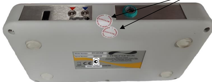
Рисунок 4 – Схема пломбировки от несанкционированного доступа расходомеров модификаций PF222 и PF333
