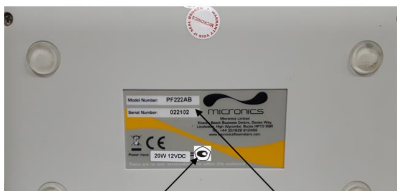
Рисунок 4 – Схема пломбировки от несанкционированного доступа расходомеров модификаций PF222 и PF333
