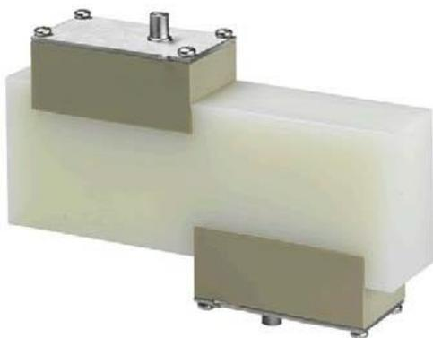
**Рис. 16 Датчики на испытательном блоке**
