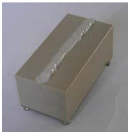
Рис. 9 Нанесение контактного ультразвукового геля
