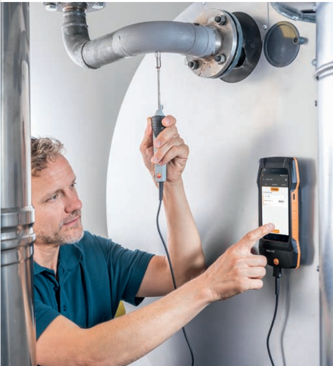
С testo 400 вы можете одновременно использовать до восьми зондов (4 с Bluetooth, 4 с кабелем)
