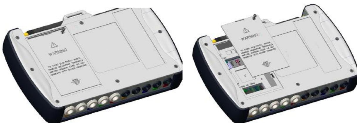
**Рисунок 2: Снятие крышки, закрывающей батарею.**
