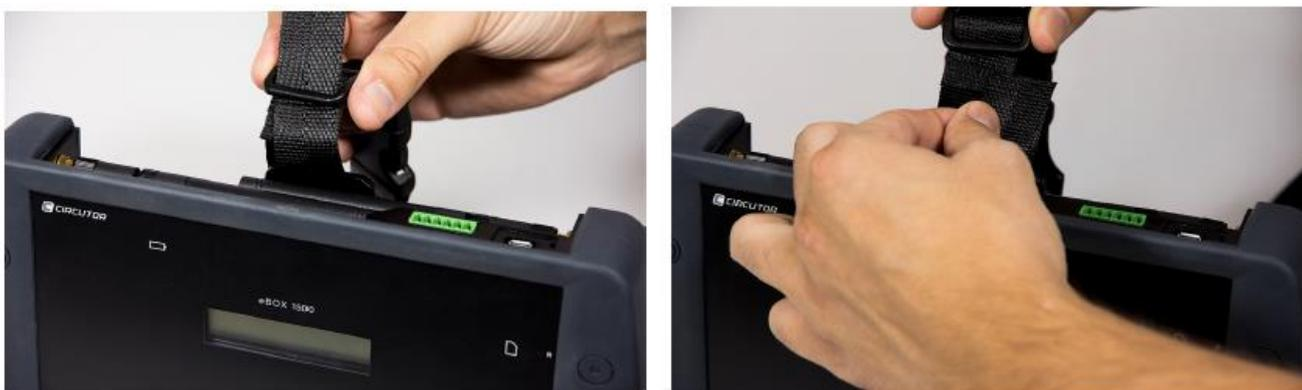
**Рисунок 6: Установка ремешка для крепления: шаги 3 и 4.**
