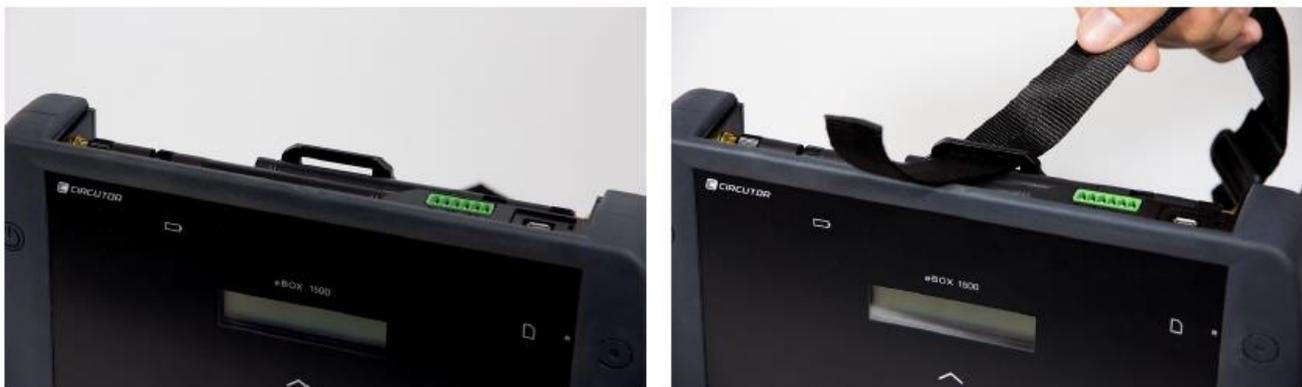
**Рисунок 5: Установка ремешка для крепления: шаги 1 и 2.**
