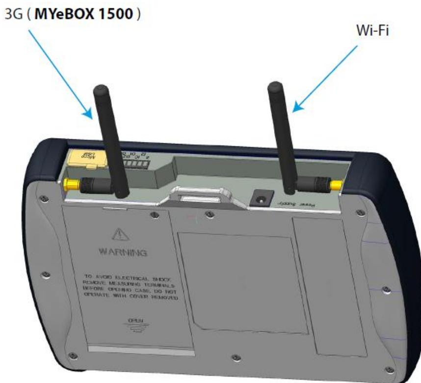
**Рисунок 48: Места расположения радиоантенн.**
